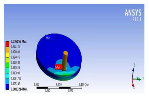
Fig. 5. Wear depth for the Taguchi parameter 9 wt%-3kg-100 rpm-1000 m.
