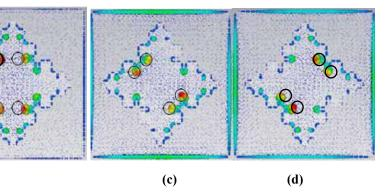
Fig 4. Surface current, at 4.5GHz (a) Mode 1 (b)Mode 2 (c) Mode 4 (d) Mode 5
