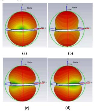
Fig 5. Farfield, at s=4.5GHz (a) Mode 1 (b)Mode 2 (c) Mode4 (d) Mode 5
