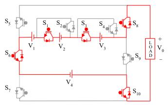
Fig. 11 -4 $V_{\text{DC}}$  output voltage
